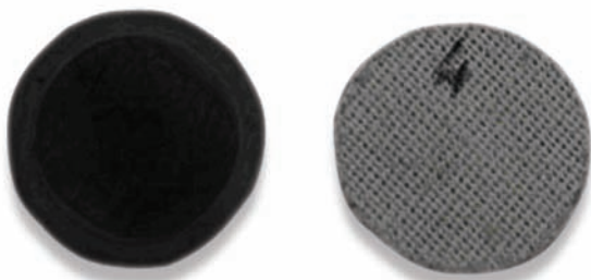
Слика 4 – Изглед испитних епрувета гумених производа након испитивања отпорности на дејство ТИНЕ
