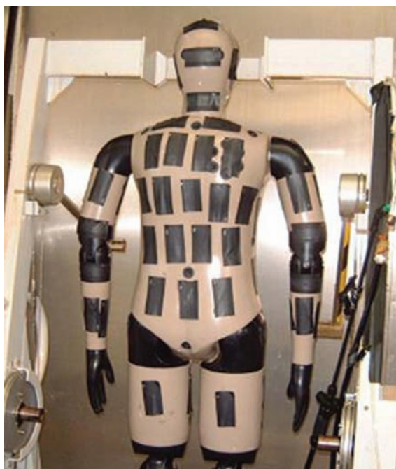
Слика 14 – Примена роботизованог манекена у испитивањима квалитета заштитних средстава
