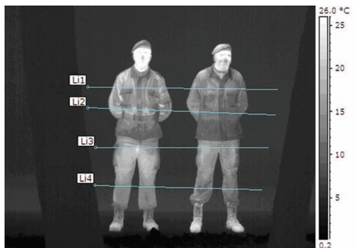
Слика 10 – Термовизијски приказ испитаника у различитим моделима војничких униформи
