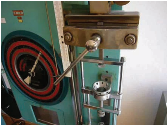
Слика 8 – Испитивање отпорности на пробијање (прскање)
