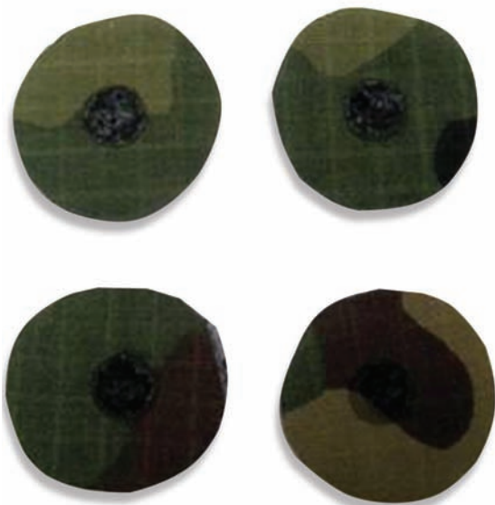
Слика 5 – Изглед испитних епрувета текстилних материјала након испитивања отпорности на дејство ТИНЕ
