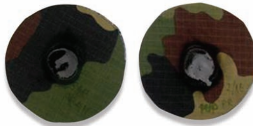
Слика 7 – Изглед испитних епрувета текстилних материјала након испитивања отпорности на дејство горуће напалм-смеше
